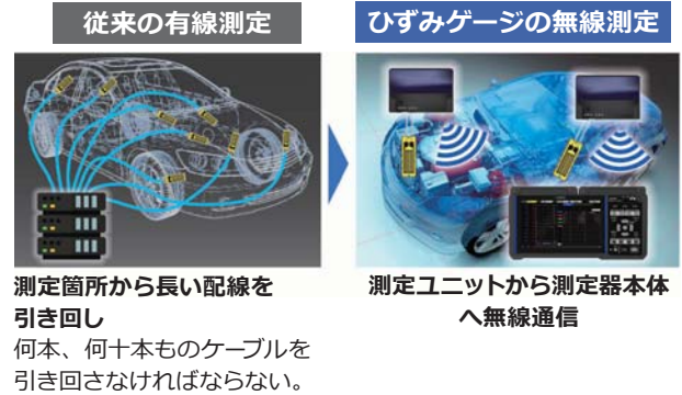
有線と無線のひずみ測定比較
