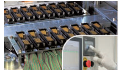
ワンタッチコネクタとタッチパネル
