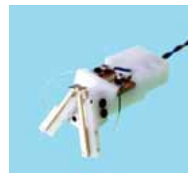
1172-64 近接4端子プローブ (150 μm仕様)
